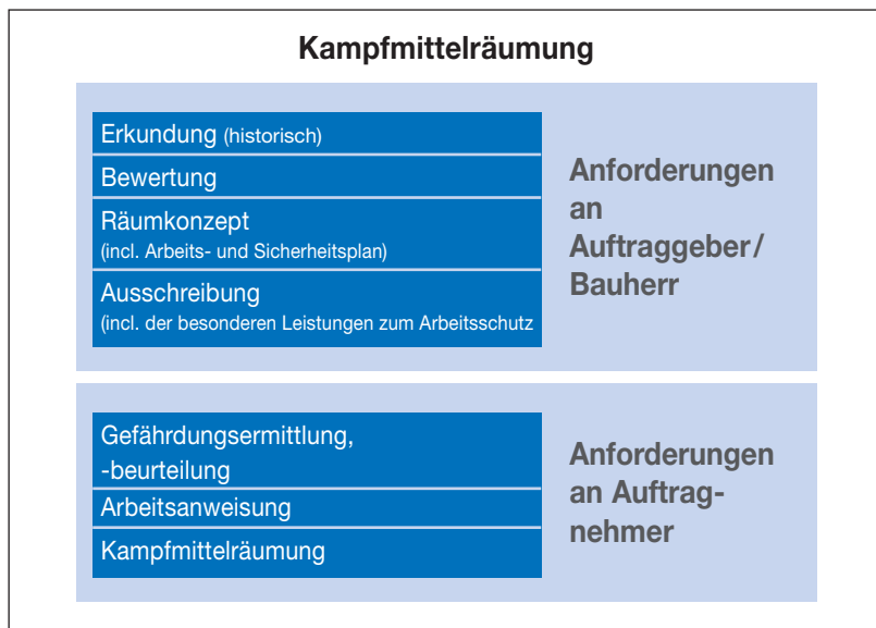
Abb. 3: Aufgabenteilung zwischen Auftraggeber und Auftragnehmer in Bezug auf den Arbeitsschutz
